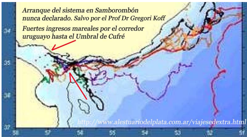
Trayectorias de nueve boyas derivantes lanzadas a lo largo de dos líneas transversales en el tramo final el Río 9 boyas de la Plata interior en febrero de 2003 (véase Piola y Osiroff, 2003)
